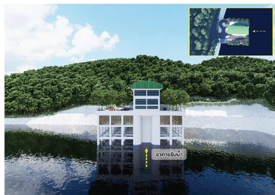
รูปที่ 7 แสดงภาพจำลองบริเวณอาคารประกอบหัวงานปากอุโมงค์ อาคารรับน้ำ ในอ่างเก็บน้ำเขื่อนศรีนครินทร์
