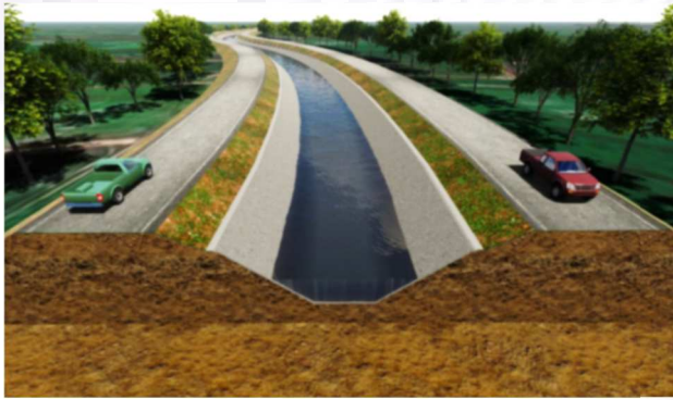
รูปที่ 16 แสดงภาพจำลองคลองส่งน้ำสายหลัก MC และตัวอย่างคลองส่งน้ำตาดคอนกรีต
